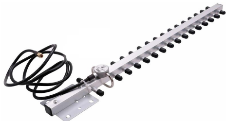
Гостронаправлені антени "хвильовий канал" ("yagi"), на фото для діапазонів 2,4/5,8 ГГц
